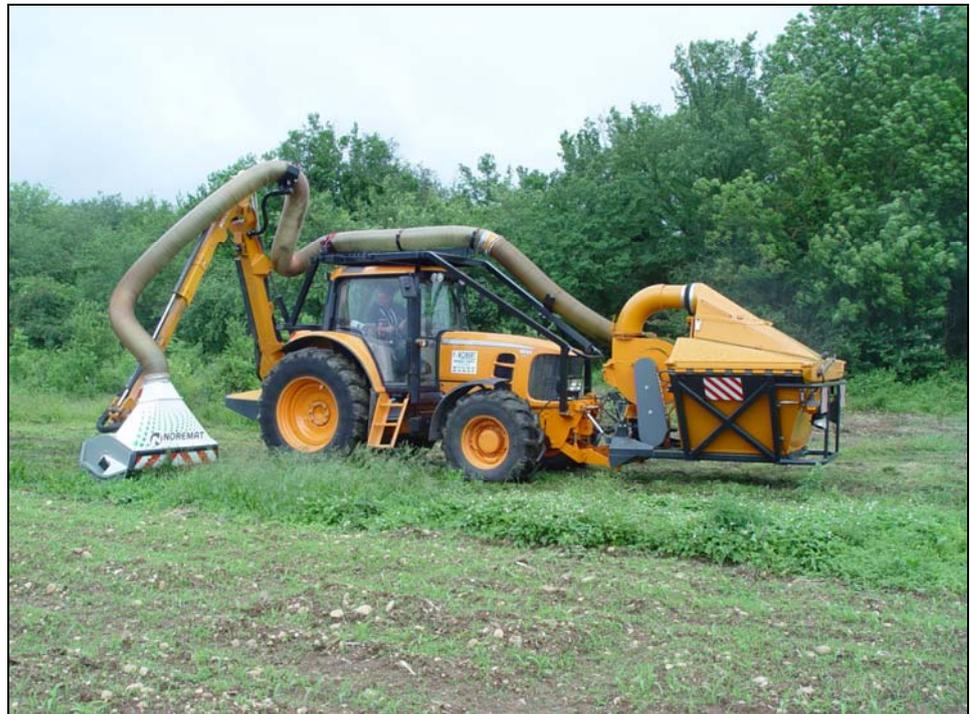
Épareuse, son bras articulé équipé d'un aspirateur et benne de m<sup>3</sup>.
