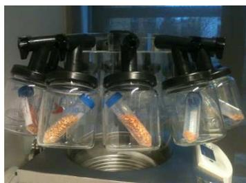
*Conditionnement des gammares avant dosage des contaminants accumulés*
