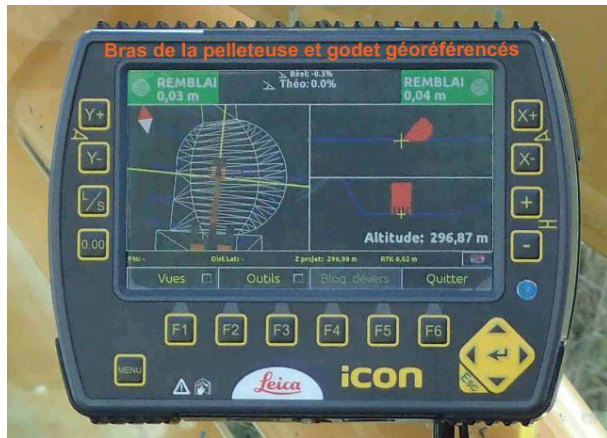
Pelleuse reliée à la station GPS (Bras et Godet géo-référencés)
