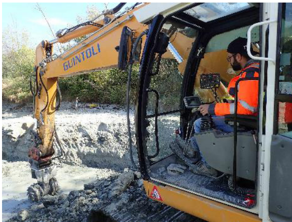
Pelleuse reliée à la station GPS (Bras et Godet géo-référencés)
