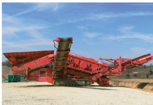
Le tri des matériaux est effectué à l'aide d'un scalpeur (à gauche ; Crédit : SOVAMAT) puis d'une finition manuelle (à droite).
