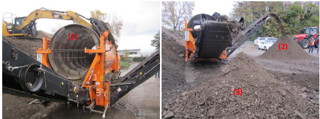
Vue de détail du Trommel rotatif (grille utilisée : 0-20 mm) (1) / Partie fine sans rhizome de renouée (2) et partie grossière contenant graviers, galets et rhizomes (3)
