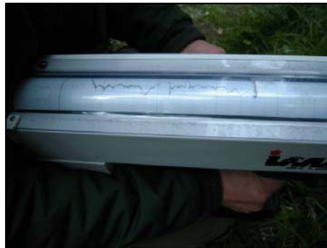
Vue de l'appareil, une aiguille inscrit un graphe selon la dureté du bois traversé
