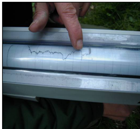
Ici, la chute de la courbe correspond à une zone de bois pourri
