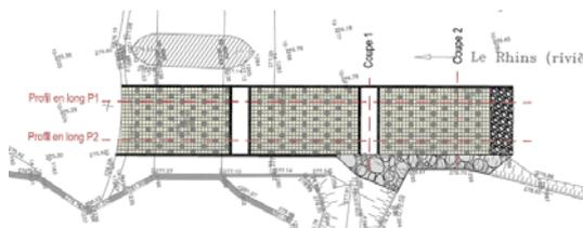
→ Adaptation du projet : modification du voile rive droite pour faciliter le coffrage (aucun incidence sur le fonctionnement hydraulique)
