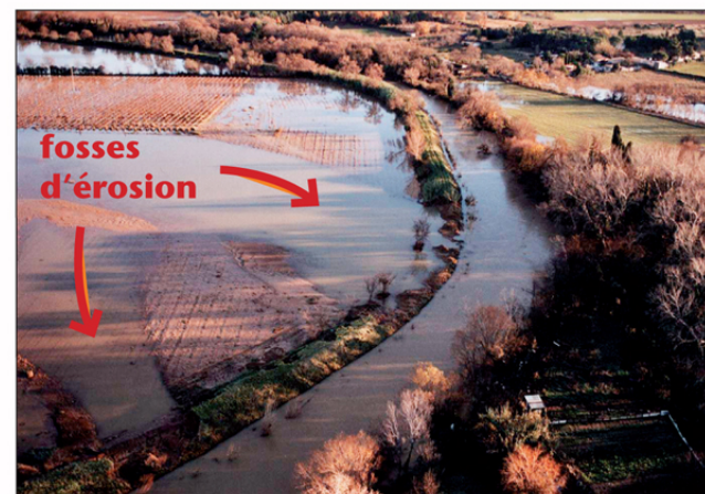
Rupture de la digue de La Mosson à Maurin (Hérault), en septembre 2002
