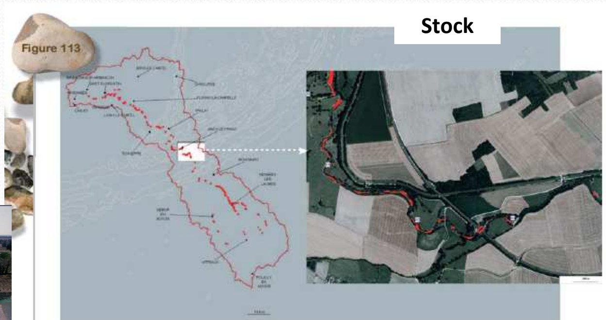
Exemple de digitalisation des bancs alluviaux (L'Armançon. Les chiffres en bleu sont les distances en Km par rapport à la confluence avec l'Yonne) (Malavoi, 2006).
