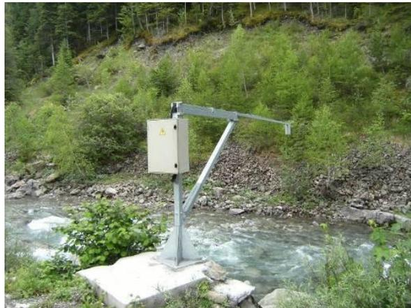
La station avec base radar permet de donner la variation de la ligne d'eau. Le radar mesure des hauteurs d'eau. En couplant ces données avec la pluviométrie et les jaugeages, une courbe de tarage peut être créée.
