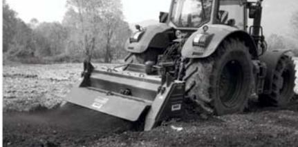
Δ Broyeur à pierres : à réserver au traitement de grandes surfaces, sur des opérations de déblai / remblai en couches minces
