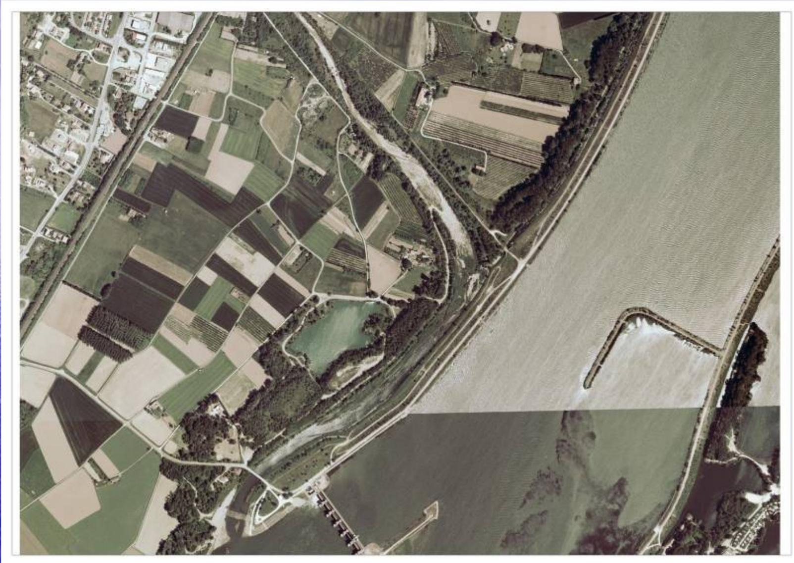
État des lieux **initial MR1 amont** : terrasses alluviales exhausés, rétraction de la bande active, tronçon rectiligne, pavage à Bmt, Bgt...
