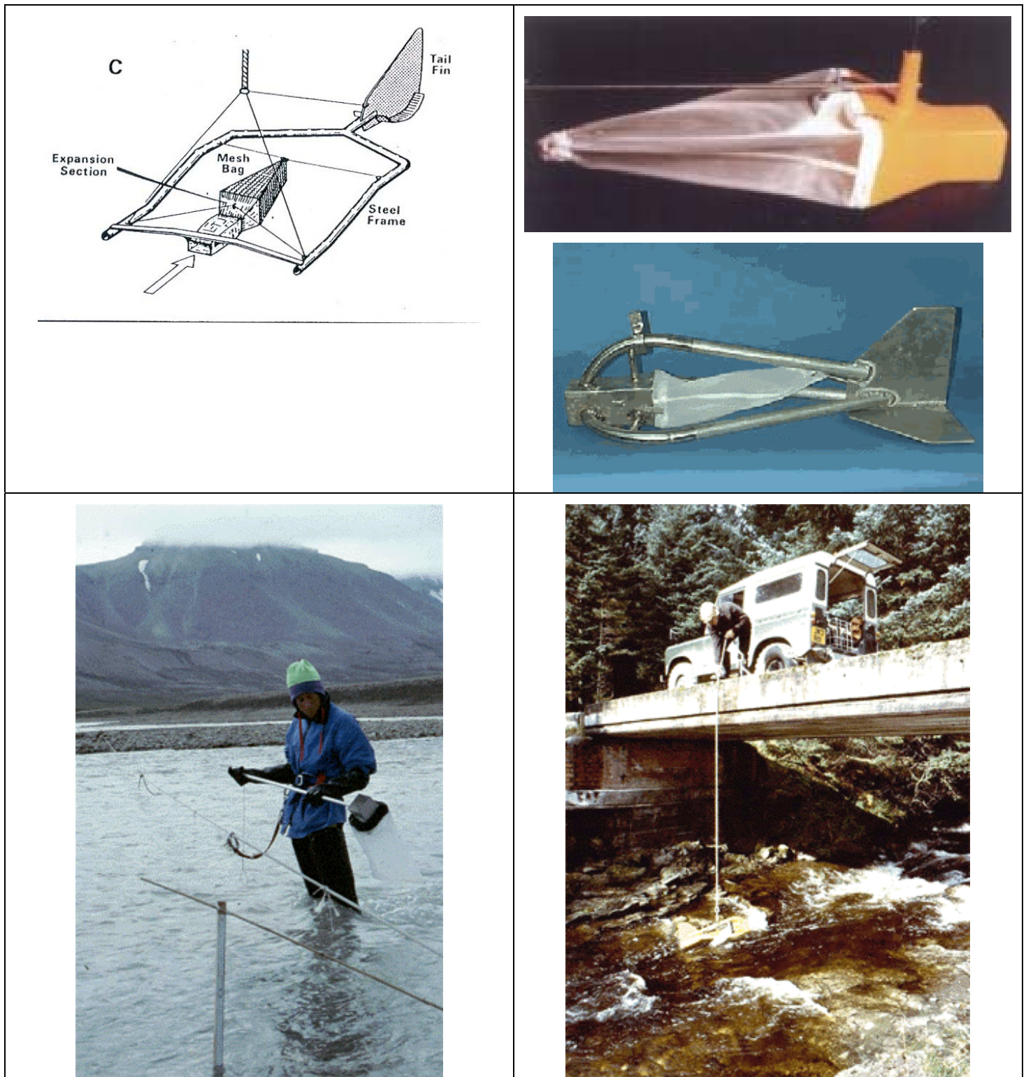
planche photo 10 : exemples d'échantillonneurs Helley-Smith ou dérivés et principes d'utilisation
