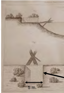
Ouvrage en fascinage dit « tunage ordinaire » (Défontaine, 1833)
