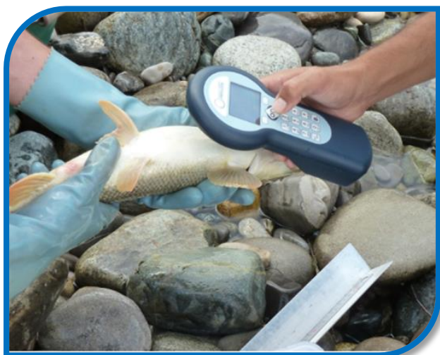
Identification de l'individu et vérification de la fonctionnalité de la puce après mesure et marquage du poisson (source : EDF)
