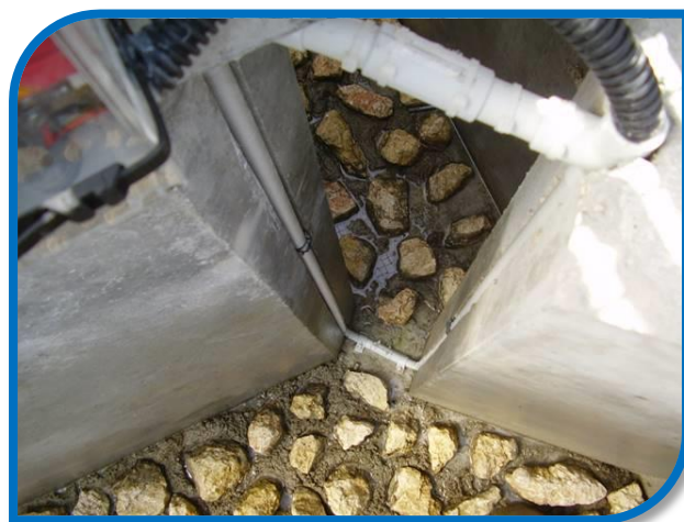
Antenne positionnée dans l'échancrure d'une cloison de la passe à poissons du Saut du Moine (source : EDF)
