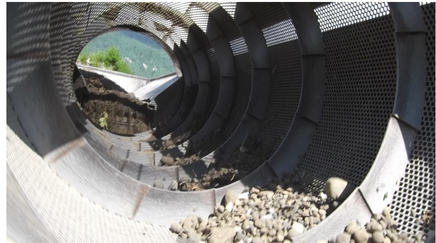
Criblage des matériaux
