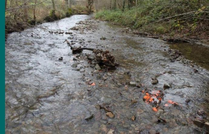
Débit de mise en mouvement  $\approx 1,9 \text{ m}^3/\text{s}$  ( $<Q1$ )
