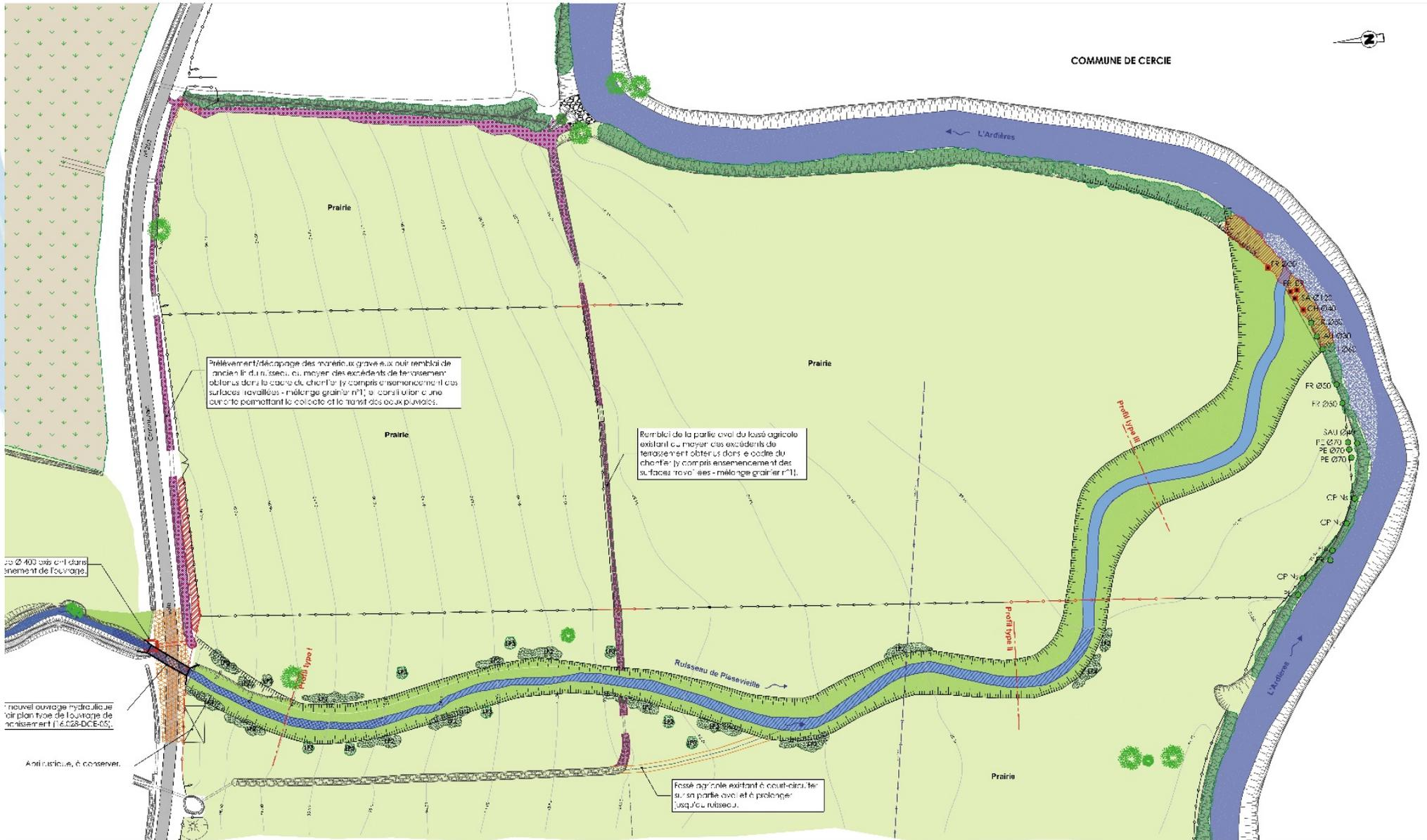
Prélèvement/décapage des matériaux graveux ou remplissage ancien lin du ruisseau, au moyen des excédents de terrassement obtenus dans la zone du chantier (y compris ensèmençement des surfaces rocheuses - mélange grainé n°1), si possible avec une couche permettant la collecte et le transit des eaux pluviales.
