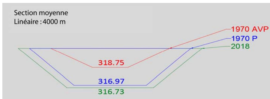
Figure 20 - Sections moyennes pré et post-travaux (1970 AVP, 1970 P et 2018).
