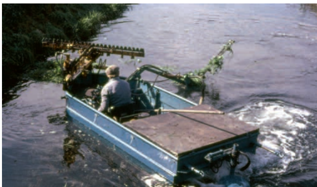
Bateaux faucardeurs équipés de barres de coupe à l'avant et latéralement.
