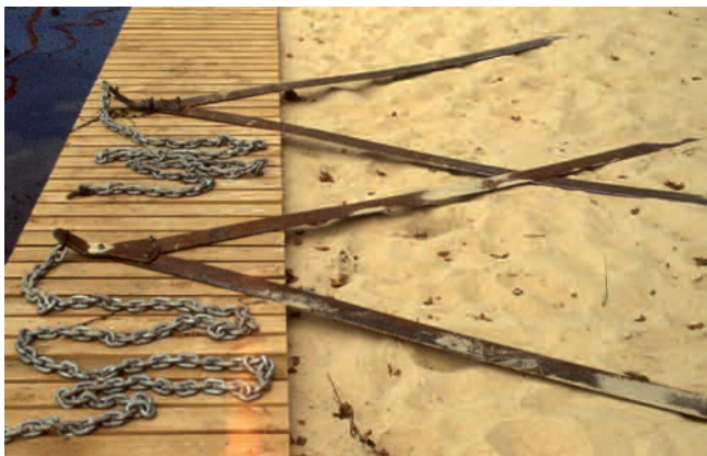
Lame de coupe tractée sur le fond.
