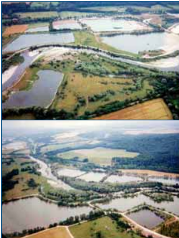
Figure 39 : Exemple de mitage du lit majeur par les exploitations de granulats, qui grèvent de manière irréversible les possibilités de recharge alluviale par érosion latérale. La mise en œuvre du concept d'espace de mobilité est impossible (la Moselle). ≡
