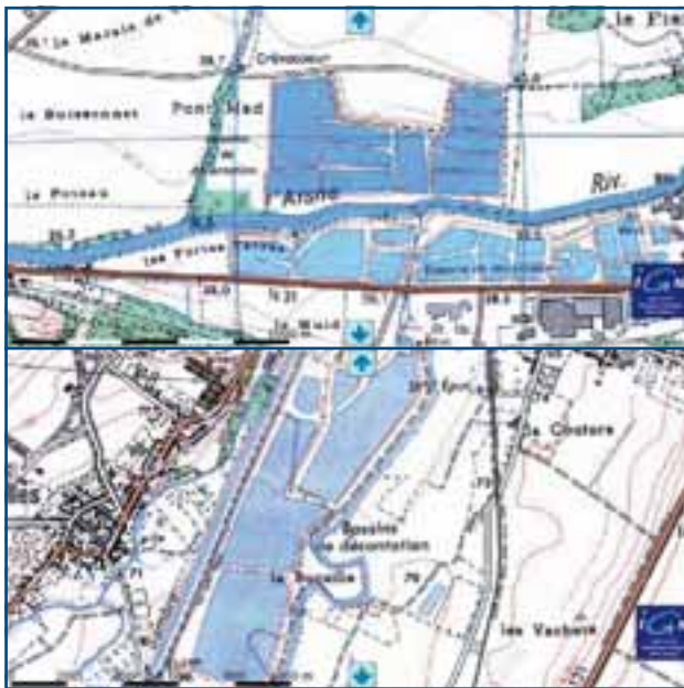
↑ Figure 38 : Exemples d'extractions en lit majeur. On observe que le lit mineur a souvent été rectifié et endigué (source : Géoportail, IGN). ≍
