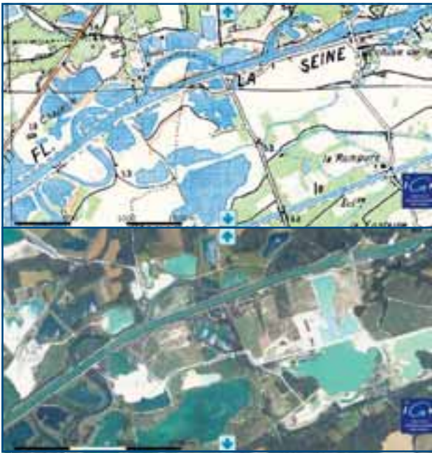
Figure 22 : Exemples de rescindements de méandres à vocation de navigation. La Seine (source : Géoportail, IGN). ≡
