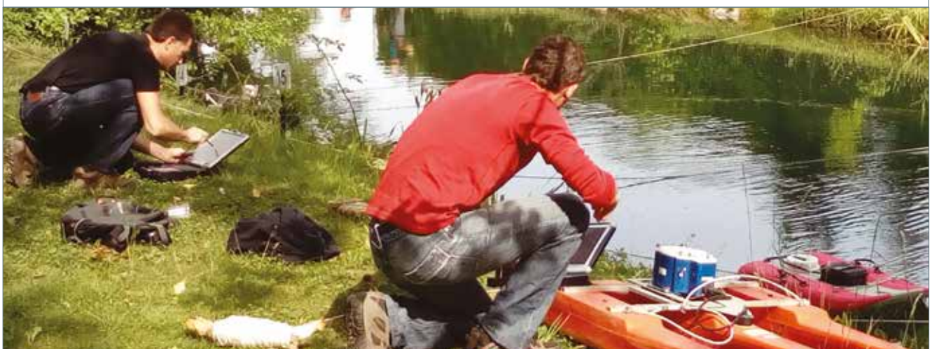
JAUGEAGE À L'ADCP (DREAL AUVERGNE-RHÔNE-ALPES)
