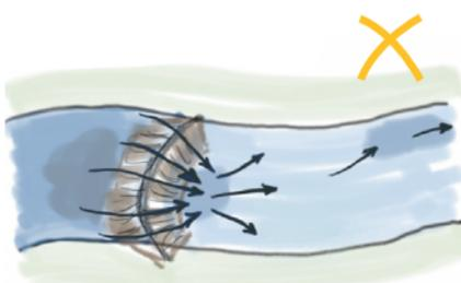
Les ouvrages de castors ressemblent rarement à l'ouvrage voute de Tignes (qui du reste n'a pas été conçu pour supporter une surverse sur sa crête). Les ouvrages à crête concave concentrent le flux à leur base, creusant une profonde fosse de dissipation susceptible d'altérer fortement l'intégrité de la structure.
