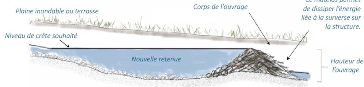
ⓘ REMARQUE : Au-dessus d'une large base dans le sens de l'écoulement, élevez progressivement la structure en construisant des couches successives de 15 à 30 cm de hauteur. Assurez-vous que chaque couche permet de retenir l'eau et de créer une retenue en amont avant de passer à la couche suivante.
