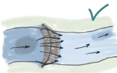
On trouve parfois des ouvrages de castors incurvés de façon convexe vers l'aval du chenal, ce qui permet de créer des flux divergents sur l'ouvrage. Ce modèle d'écoulement permet une dissipation d'énergie efficace.
