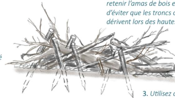
2. Plantez des pieux inclinés dans le fond du lit pour retenir l'amas de bois et stabiliser la structure, afin d'éviter que les troncs ou branches ne se détachent et dérivent lors des hautes eaux.
