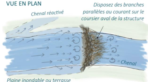
• Les ouvrages secondaires doivent être assez hauts pour envoyer la base de l'ouvrage amont. Ils peuvent aussi être construits plus haut pour abaisser la perte de charge générée par l'ouvrage amont.
