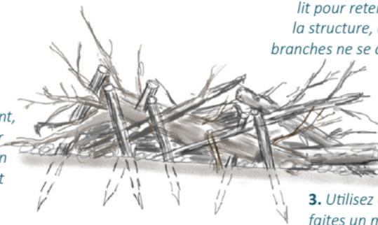
2. Plantez des pieux inclinés dans le fond du lit pour retenir l'amas de bois et stabiliser la structure, afin d'éviter que les troncs ou branches ne se détachent et dérivent lors des hautes eaux.
