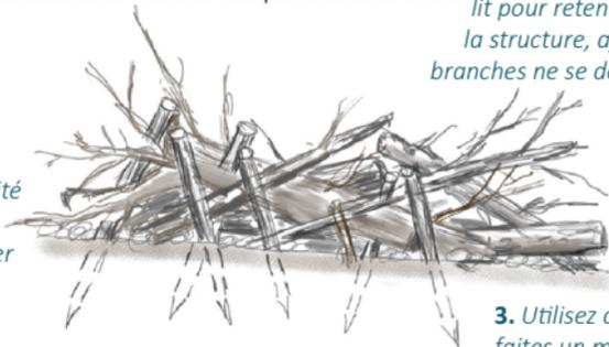
2. Plantez des pieux inclinés dans le fond du lit pour retenir l'amas de bois et stabiliser la structure, afin d'éviter que les troncs ou branches ne se détachent et dérivent lors des hautes eaux.
