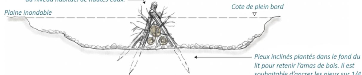
**2.** Plantez des pieux inclinés dans le fond du lit pour retenir l'amas de bois et stabiliser la structure, afin d'éviter que les troncs ou branches ne se détachent et dérivent lors des hautes eaux.
