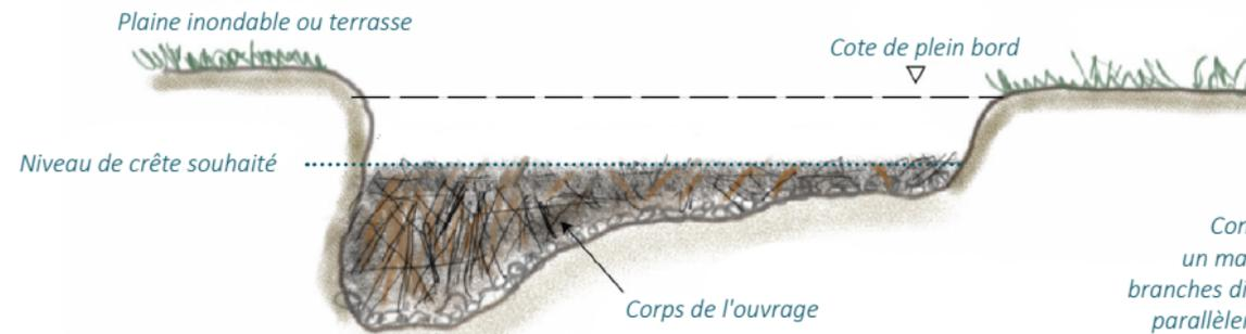
Construisez un matelas de branches disposées parallèlement au courant sur la face aval de celle-ci et ancré dans le maillage de la base. Ce matelas permet de dissiper l'énergie liée à la surverse sur la structure.
