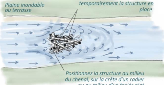
*N'hésitez pas à vous appuyer sur les branches des pièces maitresses pour positionner les pieux d'ancrage destinés à sécuriser et maintenir temporairement la structure en place.*
