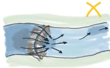
Les ouvrages de castors ressemblent rarement à l'ouvrage route de Tignes (qui du reste n'a pas été conçu pour supporter une surverse sur sa crête). Les ouvrages à crête concave concentrent le flux à leur base, creusant une profonde fosse de dissipation susceptible d'altérer fortement l'intégrité de la structure.
