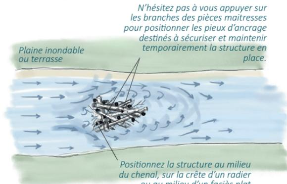
*N'hésitez pas à vous appuyer sur les branches des pièces maitresses pour positionner les pieux d'ancrage destinés à sécuriser et maintenir temporairement la structure en place.*
