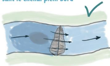
Un ouvrage qui traverse le chenal à plein bord, mais dont la crête est inférieure au niveau de la plaine inondable adjacente, contiendra les débits en basses eaux au sein du chenal. Orienté perpendiculairement au chenal, il retiendra l'eau et modifiera les flux comme si on avait un écoulement de plein bord.
