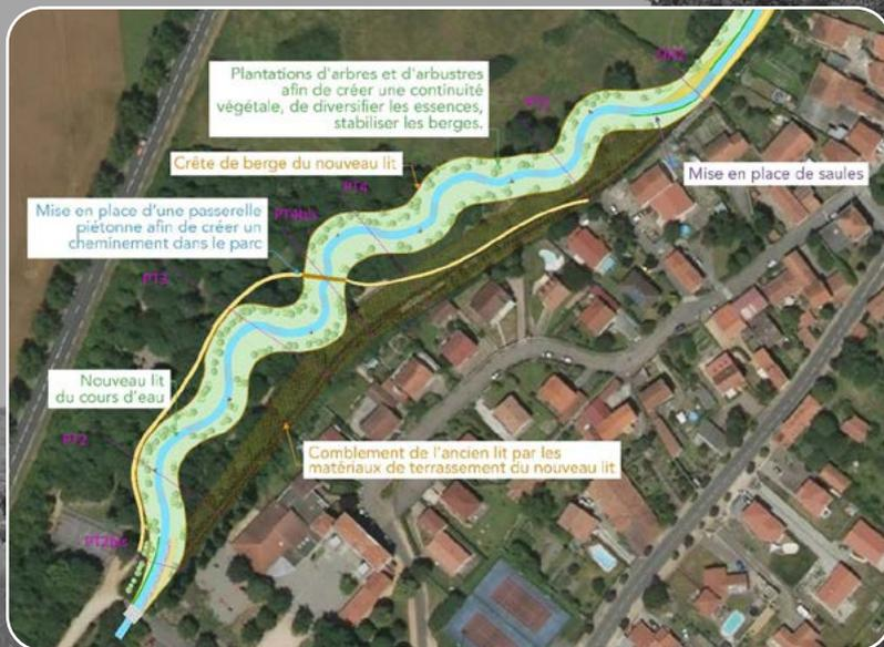
Jusqu'à la sortie du bourg et la fin de la partie canalisée du cours d'eau, il est envisagé de supprimer le béton de part et d'autre de la rivière et de faire sinuer le cours d'eau dans l'emprise actuelle tout en ajoutant des cailloux, des plantations, des blocs et des souches pour permettre des écoulements variés.
