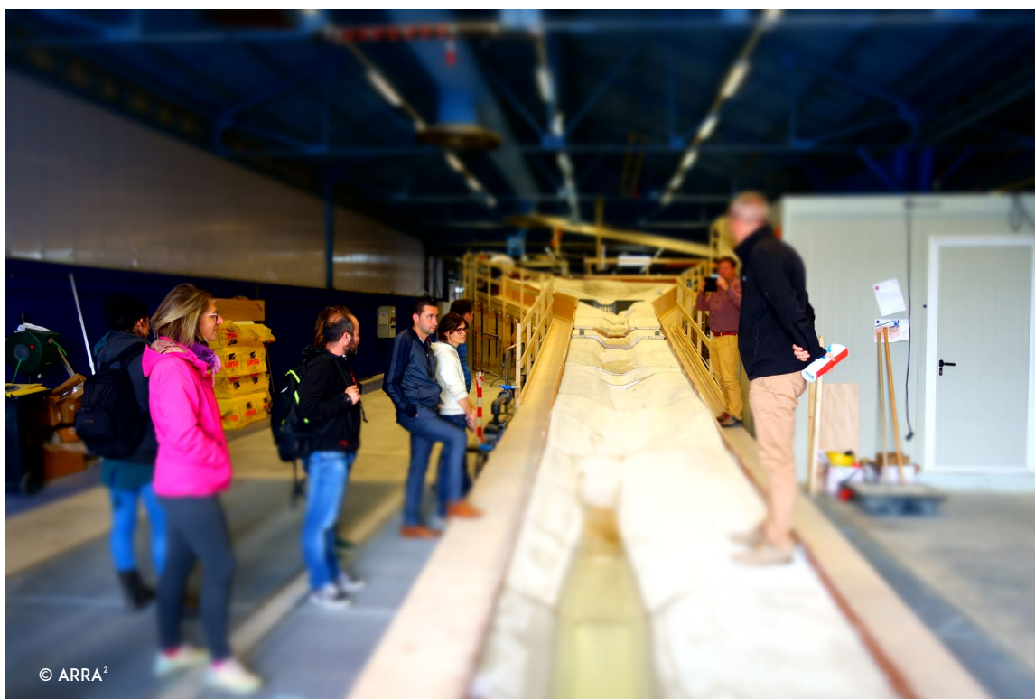
Le modèle réduit du torrent du Manival
