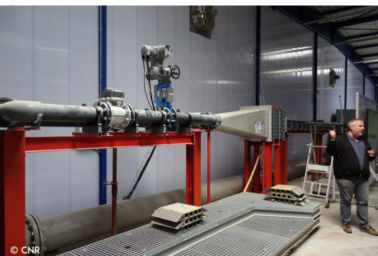
Partie amont du canal érodimètre
