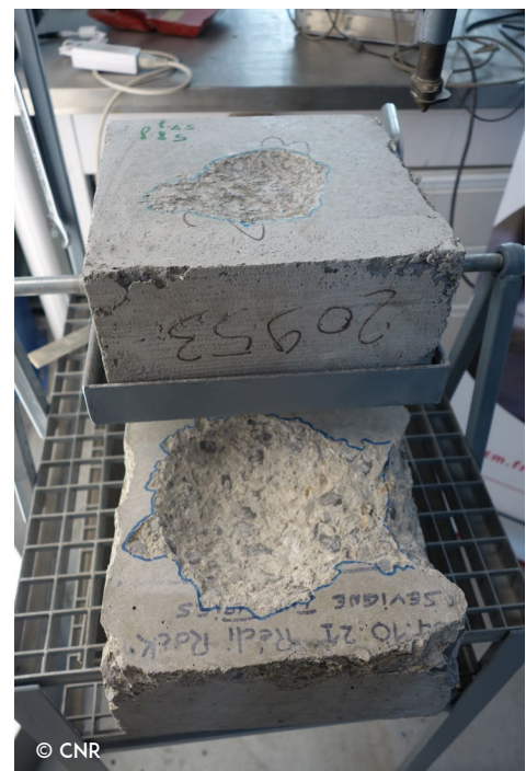
Résultat d'essais de résistance de bétons
