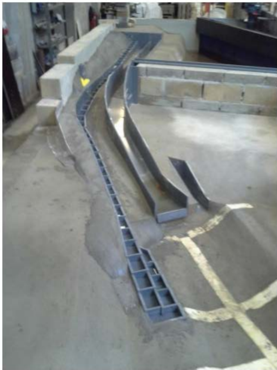
Figure 3 : Géométrie modifiée du modèle réduit – Vue générale et amont de la passe à poissons
