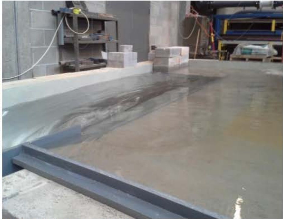
Figures 14 et 15 : géométrie existante – débit de 200 \text{ m}^3/\text{s} (source :ULg)
