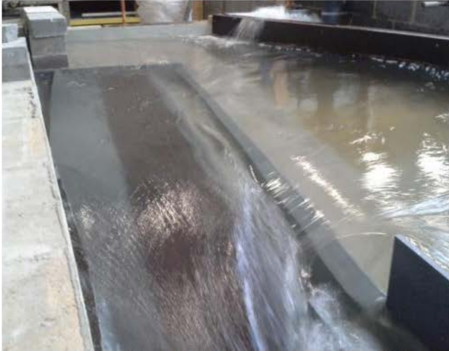
Figures 14 et 15 : géométrie existante – débit de 200 \text{ m}^3/\text{s} (source :ULg)
