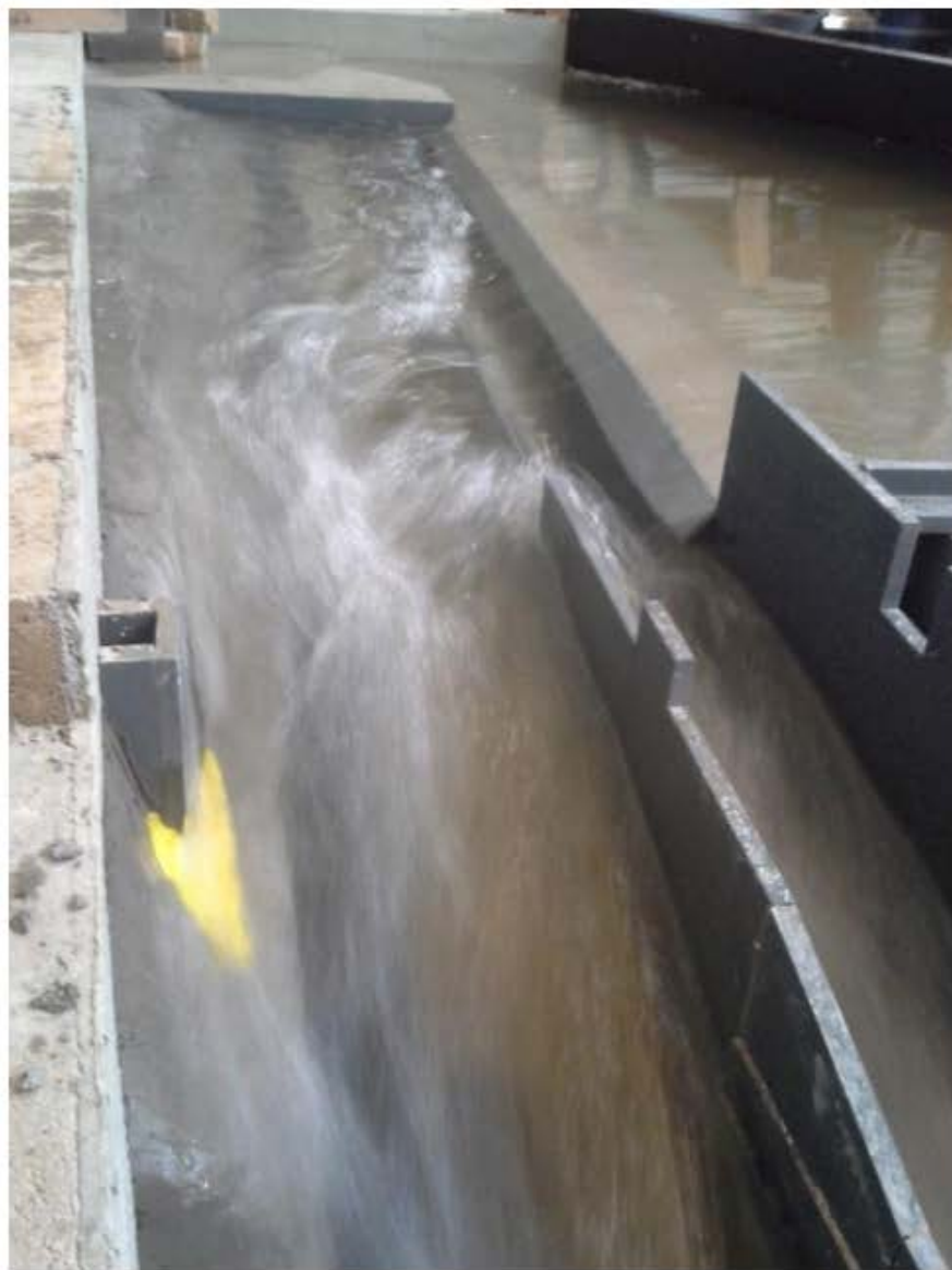
Figure 10 : Ecoulements en configuration modifiée – Débit de 150 \text{ m}^3/\text{s} – Crue de projet
