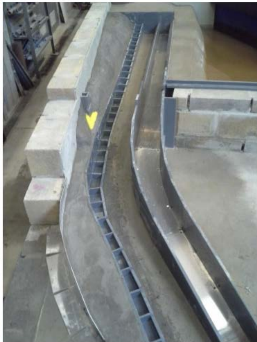
Figure 3 : Géométrie modifiée du modèle réduit – Vue générale et amont de la passe à poissons
