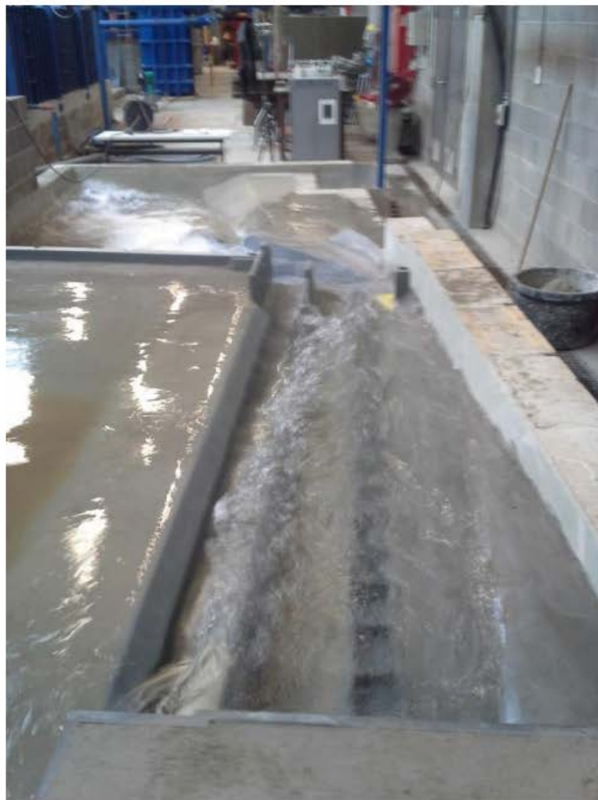
Figure 10 : Ecoulements en configuration modifiée – Débit de 150 \text{ m}^3/\text{s} – Crue de projet
