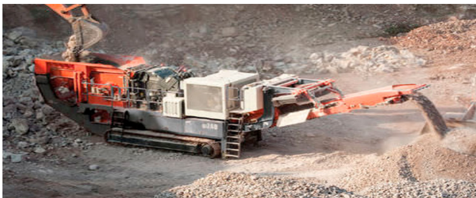
Station de concassage des matériaux
